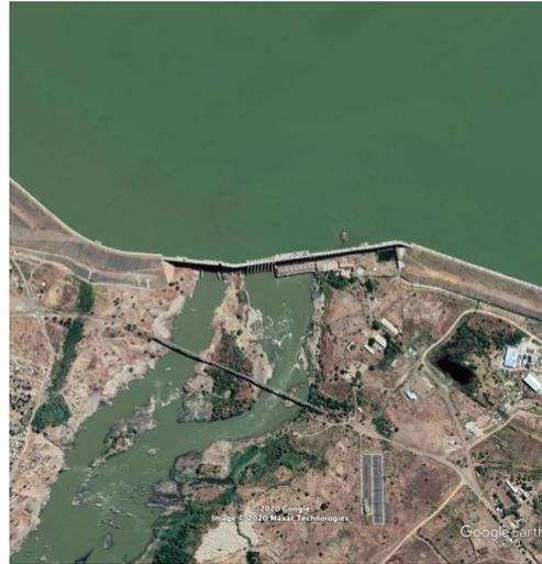
يشير تحليل أولي بسيط تم إجراؤه بالتعاون مع الدكتورة ريم دقنة إلى أنه يمكن مضاعفة قدرة توليد الطاقة الكهرومائية في الروصيرص عن طريق زيادة عدد التوربينات من ستة، كل منها بسعة 40 ميجاواط، إلى اثني عشر من نفس الحجم. يمكن وضع التوربينات الإضافية في منشآت مصممة بشكل مناسب في مواقع مختارة بعناية على الخزان (انظر الشكل أعلاه) وقريبة من السد. تكفي مجموعة من اثني عشر توربينًا للاستفادة من معظم التدفق في عام عادي.
